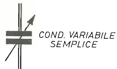
Fig. 14 - Simbolo elettrico del condensatore variabile semplice, ossia ad una sola sezione.
