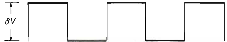
Fig. 11 - Il segnale uscente dall'oscillatore a frequenza variabile, descritto nel testo, assume la forma riprodotta in questo diagramma, con un valore di tensione di 8 ohm circa su carico ad alta impedenza.
