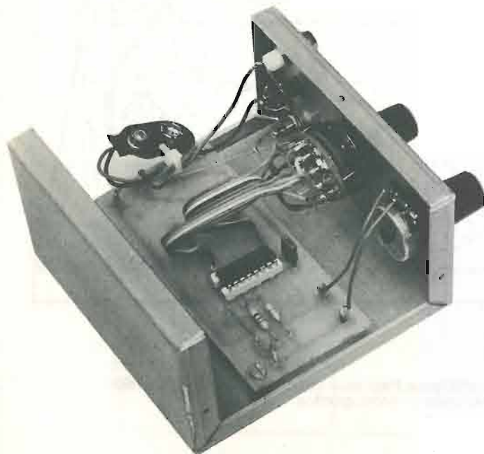
Fig. 10 - Questa foto riproduce la parte interna del dispositivo realizzato nei nostri laboratori. Si noti, in particolare, l'inserimento dell'integrato su apposito zocchetto.
